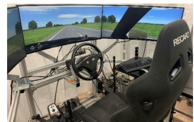
図1 実験で使用する 定置式ドライビングシミュレータ
