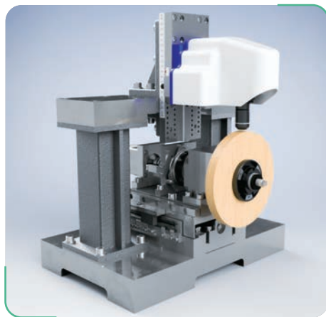
▲ 砥石表面の測定装置の開発 研削加工に用いられる“砥石”の表面状態を高精度に測定するための装置の開発。
