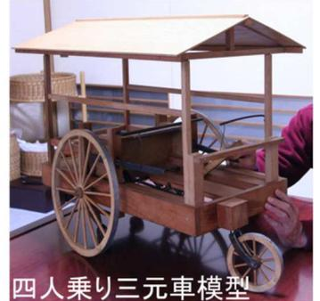
大きな車輪が駆動輪で小さな車輪が補助輪である。さらに駆動輪の脇には方向転換用小車輪が二つある。乗車エリアは二つに分かれており、運転者を含め4人が乗車できるようになっている。
