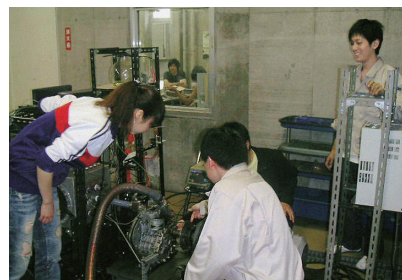
バイオ燃料性能測定用ディーゼルエンジン
