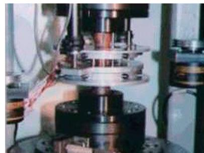
引張と剪断に関する多軸荷重実験
