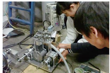
新しく設計した回生機構付きエアモータ
