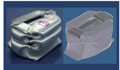
衝撃吸収部材の静的圧縮試験の形状比較
