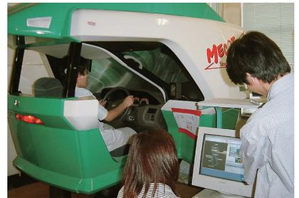
可動式ドライビングシミュレータ
