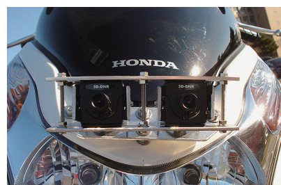
車両姿勢計測用ステレオカメラ
