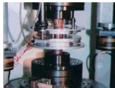
引張と剪断に関する多軸負荷実験
