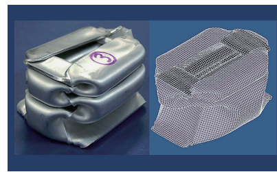
衝撃吸収部材の静的圧縮試験の形状比較
