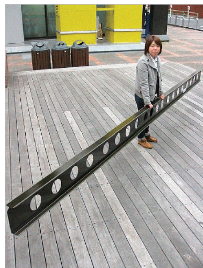
大型旅客機用の CFRP 製ビーム
